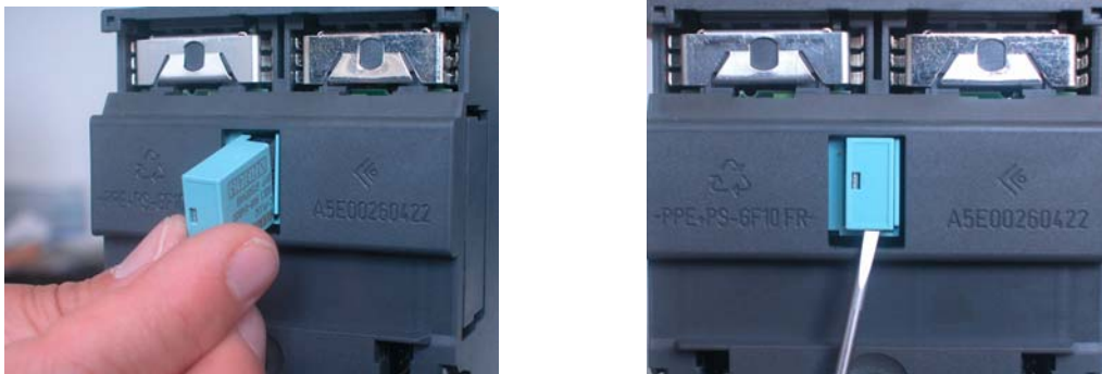
Bild 3-2 C-PLUG einsetzen und C-PLUG mit Hilfe eines Schraubendrehers aus dem CP entnehmen
